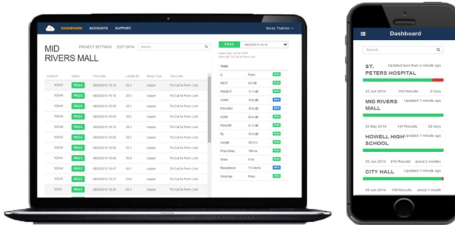
Der DSX-5000 CableAnalyzer™ wird mit dem LinkWare Live-Service verbunden, um Ergebnisse vom Prüfgerät direkt hochzuladen, wodurch ein Echtzeitzugriff auf die Prüfergebnisse von jedem Ort aus besteht.
